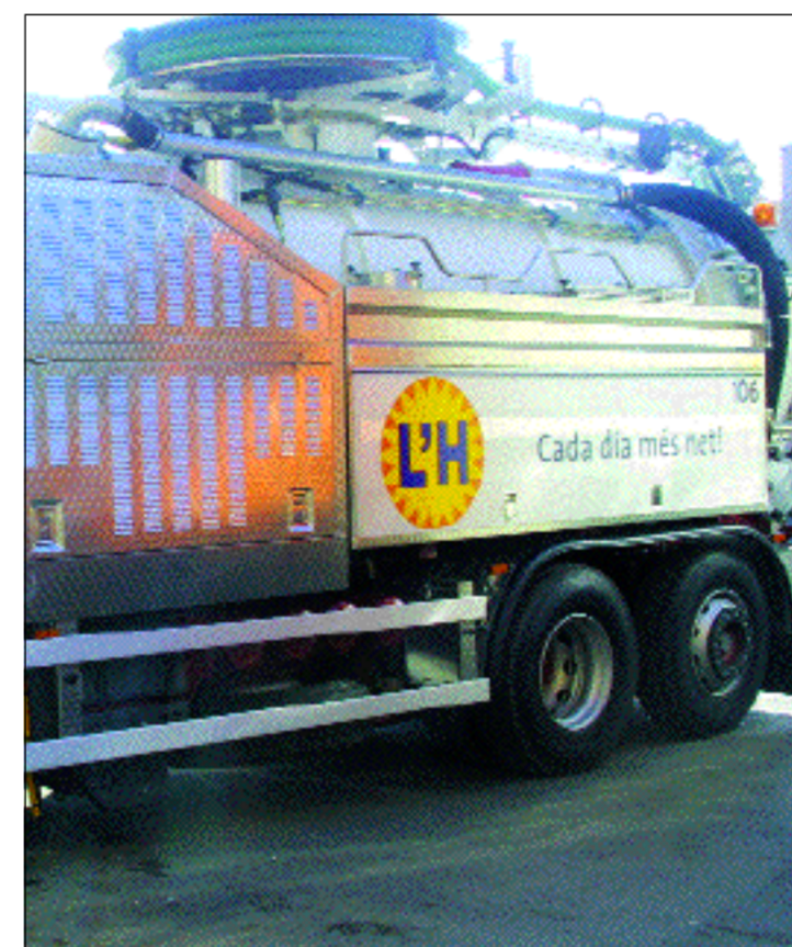
Los contenedores tendrán un espacio para materia orgánica. Este vehículo recicla el agua para limpiar el alcantarillado
